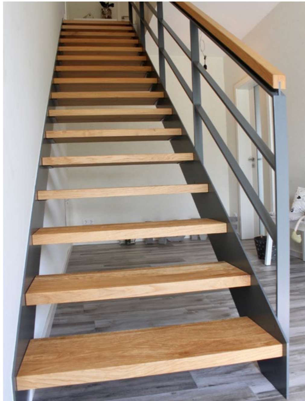
Holzart: Eiche Flachstahltrappe gebürstete Oberfläche und Handlauf auf T-Profil Basaltgrau lackierte Wangen und Flachstahlgeländer Ablage auf Brüstungswand
