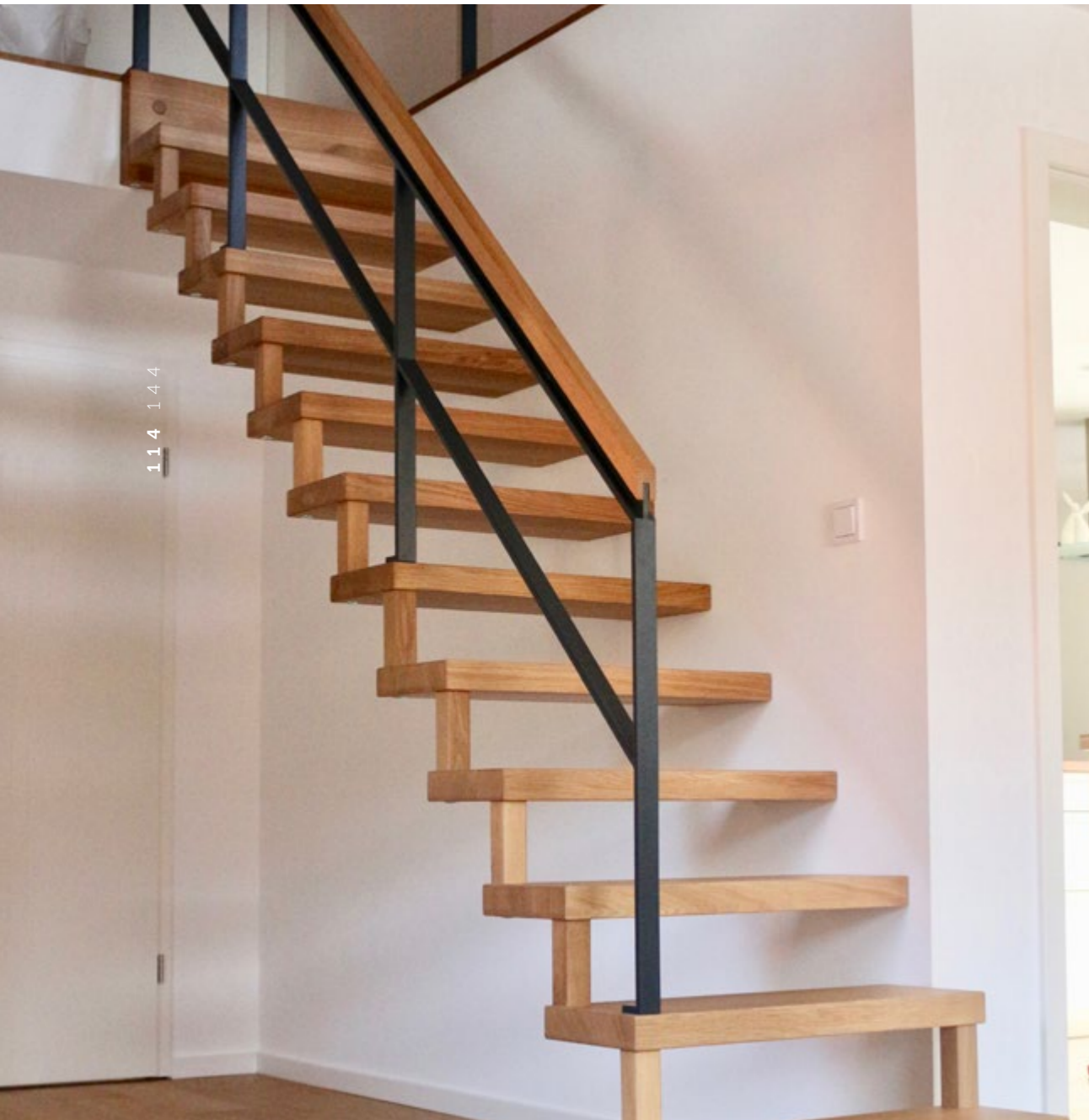
Holzart: Eiche Lamelle Raumspartreppe gebolt mit Distanzen aus Holz Flachstahlgeländer an Treppe und Brüstung
